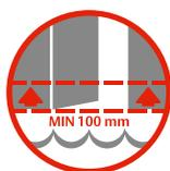
*Lors du montage à proximité du sol (distance minimale de 100 mm), il faut veiller à ce qu'aucune saleté ou eau souillée n'entre en contact avec la gâche.*
